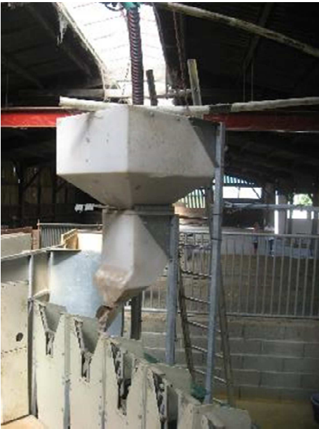
Kuva Automatoitu väkirehunjakko karuselliin.
