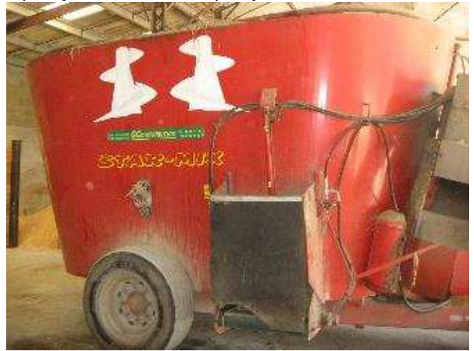
Kuva Apevaunu maissisäilörehulle ja siihen sekoitettaville rehukomponenteille.
