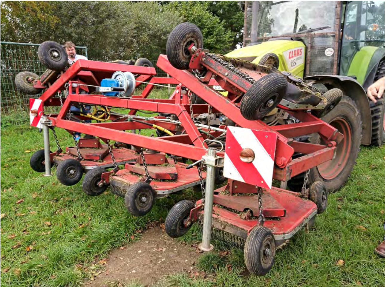
Kuva 14. Rivivälipuron leikkaamisen yhteydessä tulevat torjutuksi myös rönsyt. Glantzin tila valmistaa itse tarvitsemansa työkoneet, tässä hydraulisesti toimivat ruohonleikkurit on yhdistetty yhdeksi työkoneeksi.
