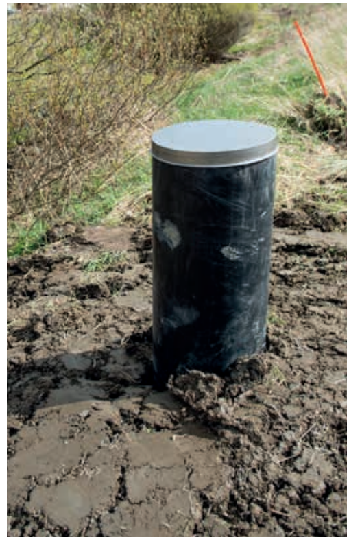
Mittauskaivo asennettuna. Kaivon sijoitettava mittauslaitteisto tuottaa reaaliaikaista tietoa salaojien virtaamista, joiden perusteella voidaan arvioida jokeen kohdistuvaa ravinnekuormitusta.
