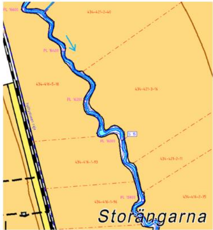
Kuva 5. Perinteinen peruskunnostus sopii ojaumastoihin, joissa korkeuserot ojapohjan ja maanpinnan välillä ovat suuret ja tilaa on vähän tehtäville toimenpiteille. Etelä-Suomen Salaojakeskus.
