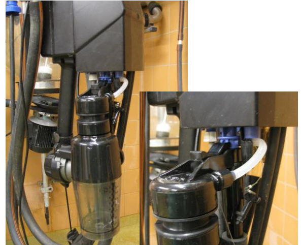
Irrota maitomittarista musta tulppa ja kiinnitä näytelaitteen silikoniletku tilalle.
