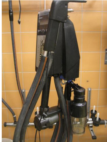
Kiinnitä näytelaite siten, että se lukittuu paikalleen. Kierrä näytepullo paikalleen.
