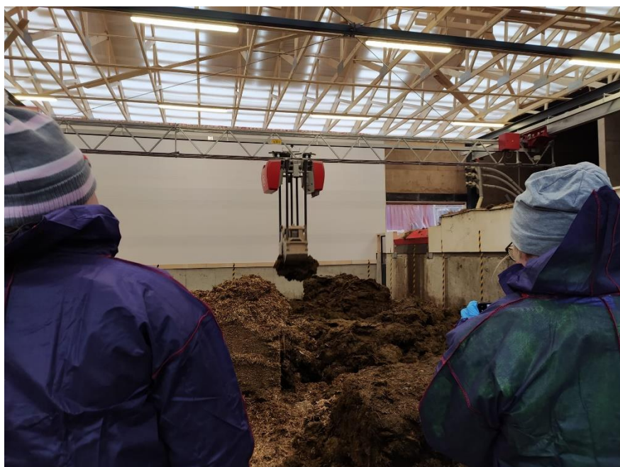
Rehukeskuksessa mekaaninen rehukahmari lastaa karkearehut, viljan ja rypsirouheen.
