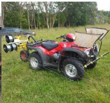
Mönkijä apuna sähköaidan pystytyksessä
