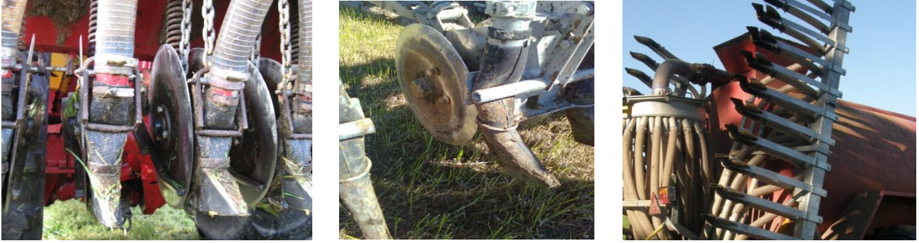
Kuva 3. Kaksoiskiekko (vasen), leveäksi muotoiltu yksöiskiekko (keskikuva) ja paksu puukkoterä (oikea) multaavaunujen vaihtoehtoina.
